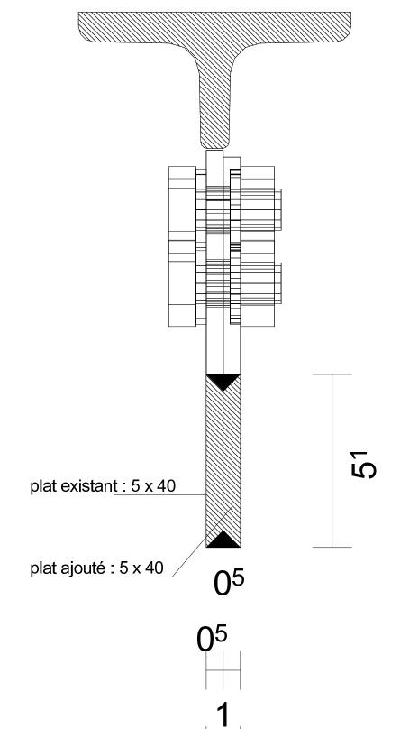
coupe de principe : cordons de soudure en quinconce (cf. plan vue de face) ép. cordon selon ép. plat (plat 5 mm)
